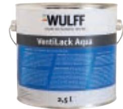
**Anwendungsbereich:** Hochwertiger, blockfester, schnell trocknender Grund-, Zwischen- und Deckanstrich für maßhaltige Holzbauteile, z.B. Fenster und Türen und für begrenzt maßhaltige Holzkonstruktionen. Auch als Endbeschichtung von grundierten Metallen geeignet. Enthält verkapselte Wirkstoffe zum Schutz der Beschichtungs Oberfläche gegen Algen- und Pilzbefall. Nur im Außenbereich einsetzen.
